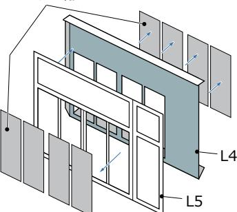
(2) 中央壁窓部の側面部を貼り付ける
